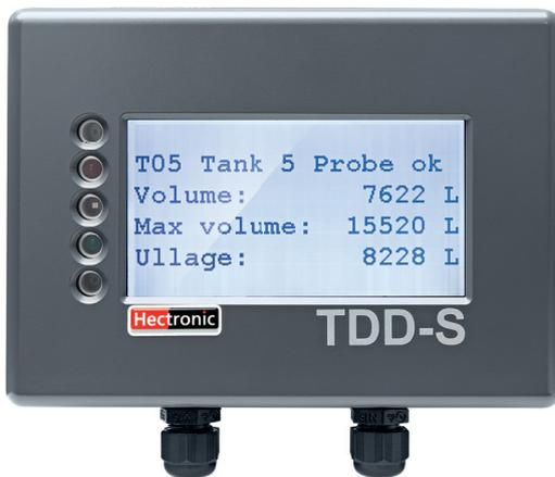
Das Truck Driver Display wird hinter einer Fensterscheibe von außen ablesbar montiert. Die Befestigung erfolgt mit Klettstreifen. Über einen Bewegungssensor, der selbst durch dicke, metallisierte Shop-Scheiben wirkt, wird das TDD-S aktiviert und die Beleuchtung eingeschaltet. Die Tankinhaltsdaten werden automatisch vom Mineo 2 Controller übermittelt.
